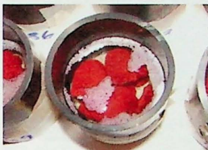
Figura 7. Impregnação de fragmentos com resina em tubo de PVC.
